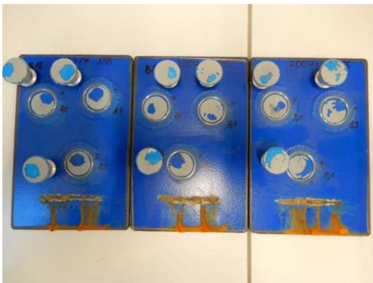
Obr. 3: Zkušební destičky po 1440 h zkoušky NSS
