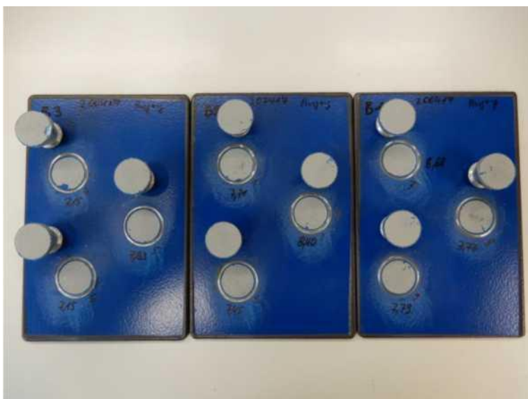
Obr. 1: Zkušební destičky po mřížkové zkoušce a odtrhové zkoušce
