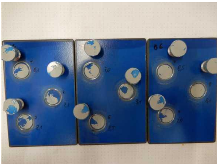
Obr. 2: Zkušební destičky po 720h expozici kondenzaci vlhkosti
