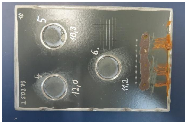
Obr. 8: P1.10 - Mřížková zkouška + Odtrhové zkoušky
