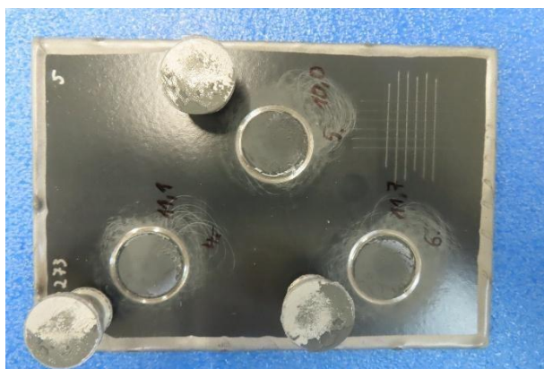
Obr. 3: P1.5 - Mřížková zkouška + Odtrhové zkoušky
