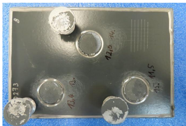
Obr. 6: P1.8 - Mřížková zkouška + Odtrhové zkoušky
