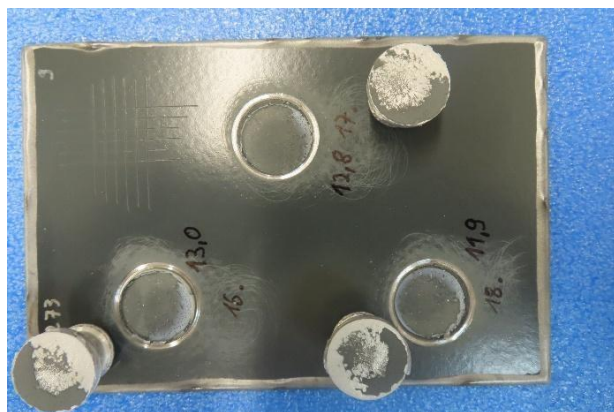
Obr. 7: P1.9 - Mřížková zkouška + Odtrhové zkoušky
